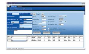
Mit der Steuerung des Viskosimeters mit der RheocalcT Software auf dem PC werden die Messdaten automatisch erfasst. Über die RheocalcT analysieren Sie die Messdaten, legen mehrere Diagramme übereinander, drucken Messdaten in tabellarischer Form, führen mathematische Berechnungen und andere zeitersparende Routinen im Handumdrehen durch. Bis zu 20 Messdatensätze können auf einen Blick verglichen werden.
